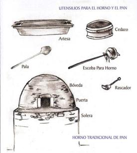
Para la construcción del horno se levanta una base de tierra, cascotes y arcilla de unos 80 cm. de altura. Sobre ésta se construye una plataforma que será el suelo del horno con una capa de arena para mantener la temperatura y losas de piedra. Esta base del horno queda cubierta por una bóveda construida con trozos de teja y arcilla y revestida con arcilla y paja. Los hornos más modernos cubren el suelo con placas de arcilla cocida y sustituyen las tejas por ladrillos refractarios.
